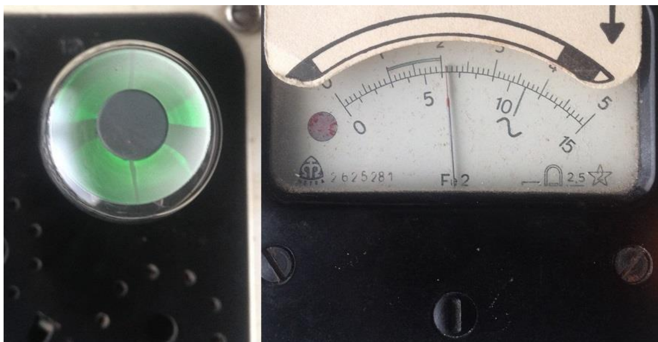
Rys.4. Pomiar lampy po drugim etapie regeneracji. Emisja około 50%.
