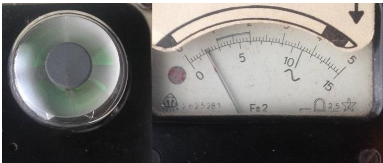
Rys.2. Lampa po pierwszym etapie regeneracji. Emisja około 10%, widoczne nierównomierne świecenie ekranu spowodowane małą emisją i wypaleniem luminoforu.
