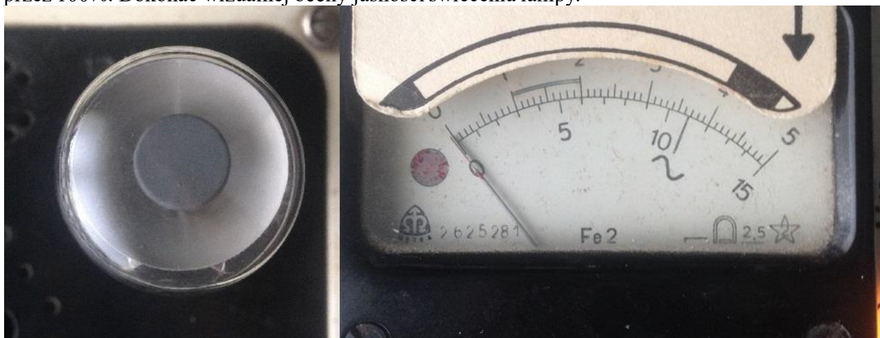
Rys.1. Lampa przed regeneracją, badana na testerze. Emisja zerowa, widoczne „wypalenie” luminoforu
